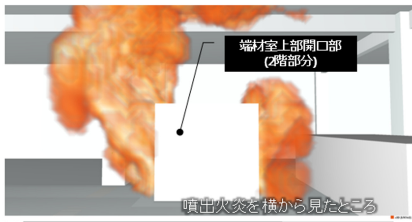
図1-2-3 端材室上部開口部（2階部分）から爆裂した柱がある方向へ噴出する火炎（シミュレーション）
